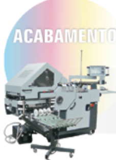
Dobradeira Digital Horizon AFC 544 AKTSC 35.000 Folhas/hora
