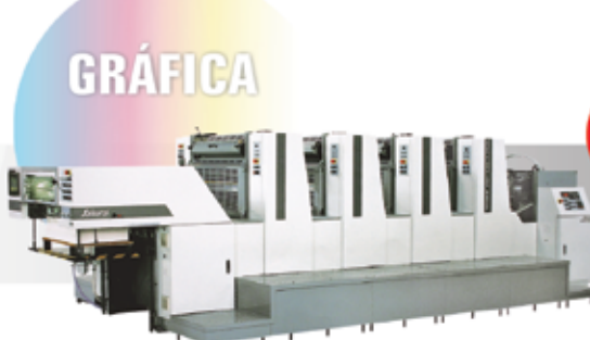
Oliver 472 ED II - 4 CORES Impressão à 13.000 fl/h à 225 linhas 3000 dpi
